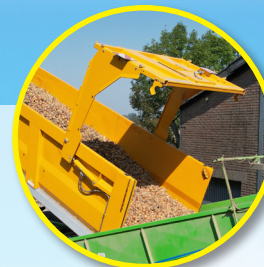
Zeer grote deuropening, met afdichting
